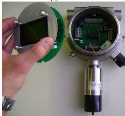
4. Для подключения ССС-903 с опцией «выносного» сенсора – необходимо отключить монтажные провода, соединяющие преобразователь ПГУ с трансмиттером ССС, отжав отверткой подпружиненные контакты соответствующего разъема:
